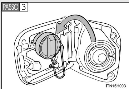
Mantenha a tampa fixada atrás da tampa do reservatório de abastecimento.
