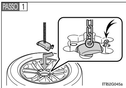
Coloque o pneu com o lado externo voltado para cima, e prenda o suporte de retenção conforme indicado na ilustração.
