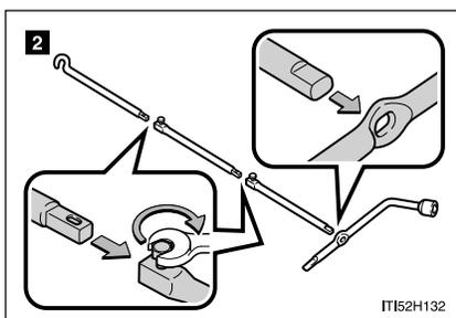
**1** Monte a extremidade, as extensões da alavanca do macaco e a chave de roda e aperte os parafusos. Verifique se os parafusos estão apertados firmemente.
