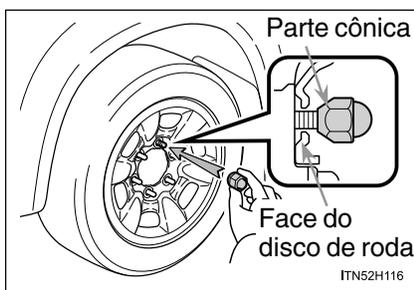
Ao substituir uma roda de aço por outra roda de aço, aperte as porcas até que a parte cônica esteja em contato com a face do disco da roda.
