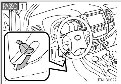
Segure o volante de direção e pressione a alavanca para baixo.
