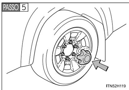
Veículos com pneu de reserva do mesmo tipo de roda dos pneus instalados: Reinstale a calota.
