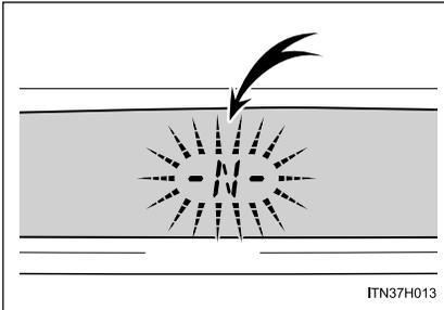
Se o mostrador de direção na bússola piscar, será necessário executar a calibração em círculo.
