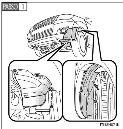
Para permitir espaço de trabalho suficiente, gire o volante de direção para o lado oposto da lâmpada a ser substituída.
