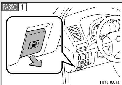
Puxe o dispositivo de abertura para abrir a tampa do reservatório de abastecimento.
