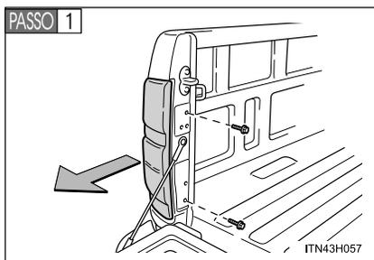
Remova os parafusos de fixação e remova a unidade.
