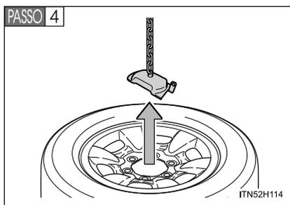
Remova o suporte de retenção e retire o pneu de reserva.
