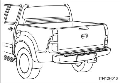
O para-choque com degrau foi projetado para a proteção traseira e para facilitar o carregamento do veículo.
