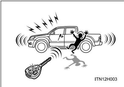
Quando (🔊) for pressionado durante mais de 1 segundo, um alarme soará intermitentemente e as luzes do veículo irão piscar para dissuadir qualquer pessoa de invadir ou danificar o veículo. Para interromper o alarme, pressione qualquer interruptor no controle remoto.
