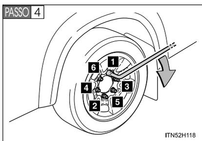
Aperte firmemente cada porca duas ou três vezes na sequência indicada na ilustração.
