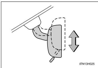
Ajuste a altura do espelho retrovisor movendo-o para cima e para baixo.
