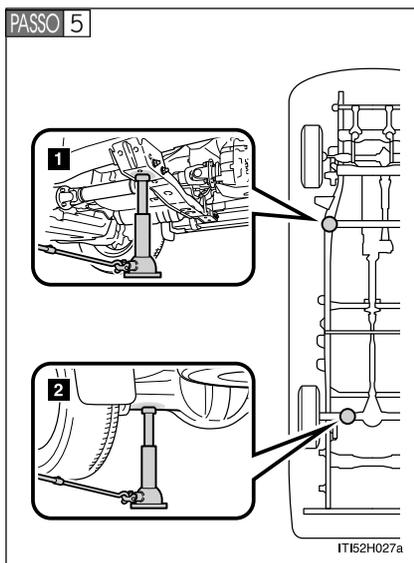
Posicione o macaco nos pontos de levantamento conforme indicado.
