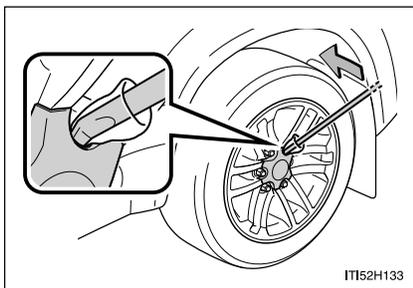
Puxe a calota, usando a extremidade chanfrada da chave de roda, conforme ilustrado.
