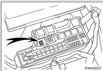
Os fusíveis tipos A e B poderão ser removidos usando a ferramenta de remoção.
