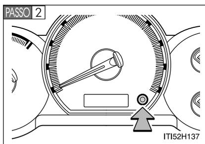
Pressione o botão no conjunto dos instrumentos. Mantenha o botão pressionado por no mínimo 10 segundos após posicionar a chave de ignição em “ON”, até que o mostrador indique “ON”.
