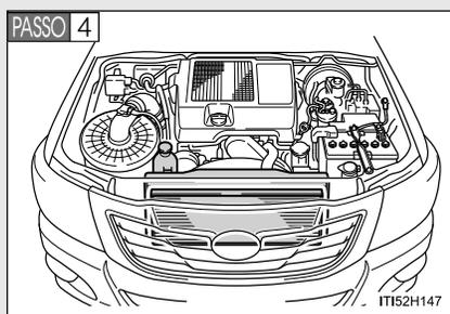
Após o motor esfriar suficientemente, verifique o nível do fluido de arrefecimento e inspecione o núcleo do radiador quanto a vazamentos.
