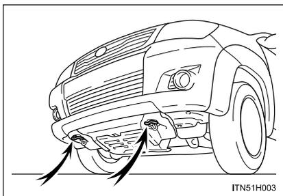
Se o caminhão de reboque não estiver disponível, em caso de emergência o seu veículo poderá ser rebocado temporariamente usando um cabo ou corrente fixados no(s) olhal(is) de rebocamento de emergência.
