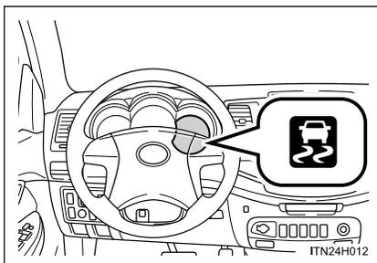
Se o veículo estiver em risco de derrapagem ou patinamento de uma das rodas de tração, a luz indicadora de patinamento irá piscar para indicar que os sistemas VSC/TRC estão em funcionamento.
