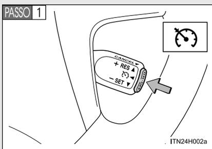
Pressione o botão “ON-OFF” para ativar o sistema de controle de velocidade.
