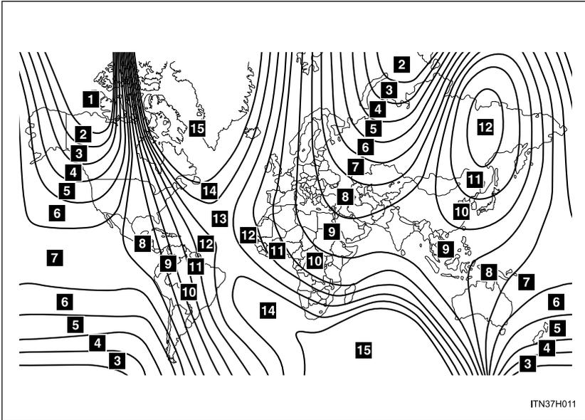
O mostrador de direção na bússola desvia da direção real determinada pelo campo magnético da terra. A quantidade de desvio varia conforme a posição geográfica do veículo.
