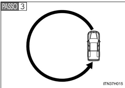
Dirija o veículo a uma velocidade de 8 km/h ou inferior em círculo até que a direção seja apresentada no mostrador.
