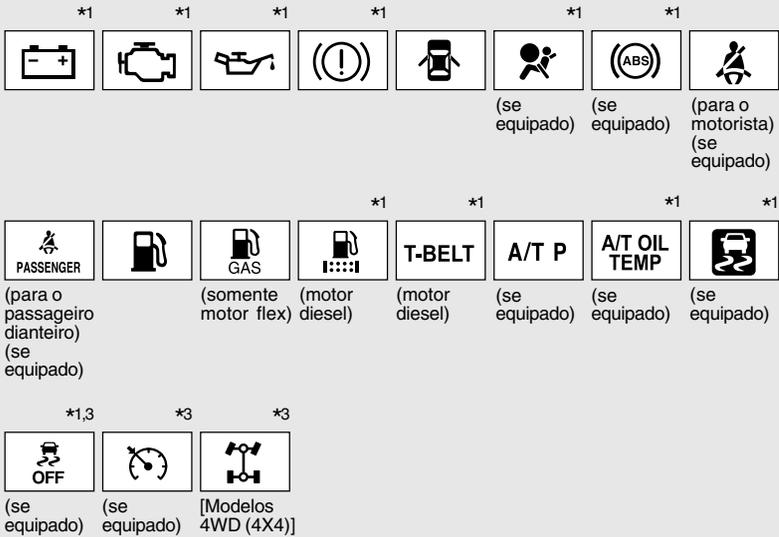
\*1: Estas luzes irão acender quando a chave de ignição for posicionada em “ON” para indicar que a inspeção do sistema está sendo executada. As luzes irão apagar após a partida do motor, ou após alguns segundos. Poderá haver impropriedade em um sistema se uma luz não acender, ou se as luzes não apagarem. Providencie a inspeção do veículo em uma Concessionária Autorizada Toyota.
