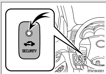
A luz indicadora começará a piscar quando a chave for retirada da ignição, indicando que o sistema está em funcionamento.
