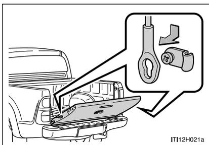
Solte os suportes nos cabos de apoio das travas, em ambos os lados, como indicado na ilustração.
