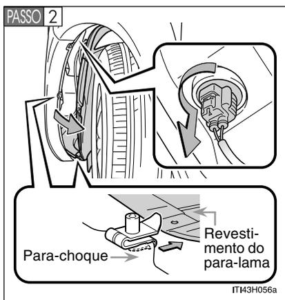
Remova parcialmente o revestimento do para-lama e gire a base da lâmpada no sentido anti-horário.
