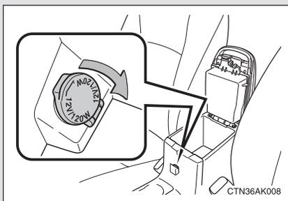
O baixo relevo próximo à trava da tampa do console central foi confeccionado para permitir a passagem de fiações elétricas, como o cabo de um carregador de celular, por exemplo.
