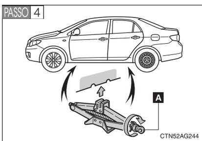
Manualmente gire a área "A" do macaco até que o entalhe do macaco esteja em contato com o ponto de levantamento.
