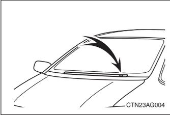
O sensor poderá não funcionar corretamente se um objeto for posicionado sobre o sensor, ou se algum objeto for fixado no pára-brisa causando obstrução do sensor.
