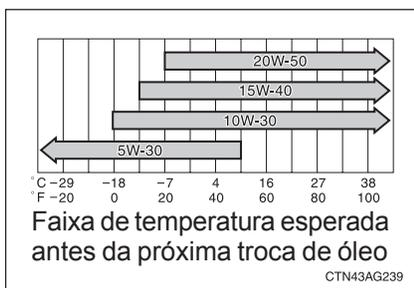
Se for usado óleo SAE 10W-30 ou um óleo com alta viscosidade quando as temperaturas estiverem excessivamente baixas, poderá ocorrer dificuldade na partida do motor, portanto é recomendado o óleo SAE 5W-30.
