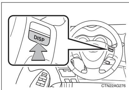
Veículos com interruptores de áudio no volante de direção: Itens que também podem ser comutados pressionando-se o interruptor "DISP".
