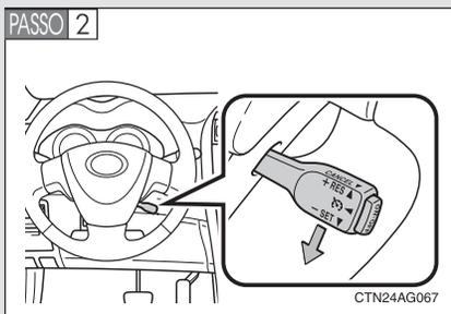
Acelere ou desacelere à velocidade desejada e pressione a alavanca para baixo para selecionar a velocidade.
