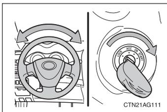
Durante a partida do motor, a chave de ignição poderá parecer estar emperrada na posição “LOCK”. Para liberar, gire a chave e mova o volante de direção levemente em qualquer sentido.
