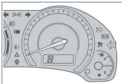
**Este indicador se acende quando a chave de ignição é colocada na posição “ON”. Ele se apaga após aproximadamente 6 segundos. Isto significa que os airbags estão funcionando adequadamente.**
