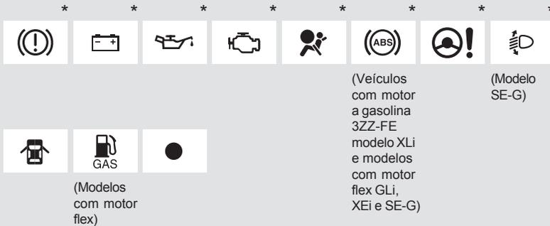
\*: Estas luzes irão acender quando a chave de ignição for posicionada em “ON” para indicar que a inspeção do sistema está sendo executada. As luzes irão apagar após a partida do motor, ou após alguns segundos. Poderá haver impropriedade em um sistema se uma luz não acender, ou se as luzes não apagarem. Providencie a inspeção do veículo em uma Concessionária Autorizada Toyota.
