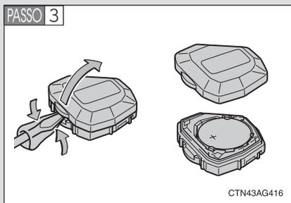
Abra a tampa usando uma chave de fenda protegida com tecido, etc. e remova a bateria descarregada.
