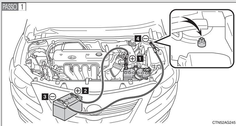
Conexão dos cabos-ponte.
