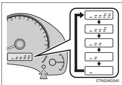
Pressionar e manter pressionado o botão, irá ajustar a intensidade de iluminação do painel de instrumentos.
