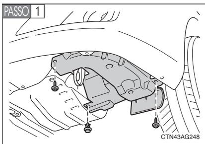
Remova os parafusos do revestimento do pára-lama e a presilha.
