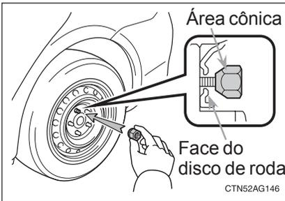
Aperte as porcas até que a parte cônica esteja em contato com a face do disco da roda.
