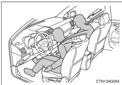
O pré-tensionador possibilita uma maior proteção do ocupante ao retrain rapidamente o cinto de segurança quando o veículo é submetido a determinados tipos de colisão frontal grave.
