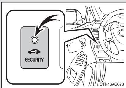
A luz indicadora começará a piscar quando a chave é retirada da ignição, indicando que o sistema está em funcionamento.
