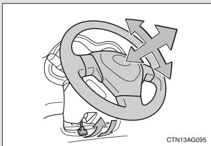
**PASSO 1** Segure o volante de direção e mova a alavanca para baixo.
