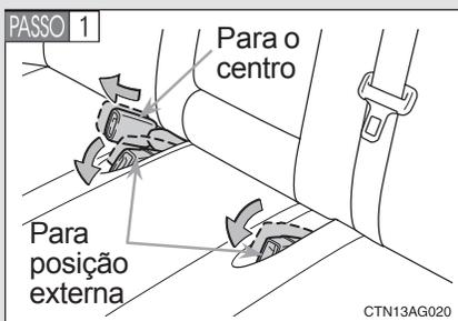
Acondicione as fivelas dos cintos de segurança das posições externas do banco traseiro e mova a fivela do cinto da posição central conforme indicado.
