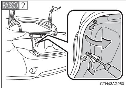
Usando uma chave de fenda, remova as presilhas da cobertura de acabamento do compartimento de bagagem. Parcialmente remova a tampa de acabamento do compartimento de bagagem.
