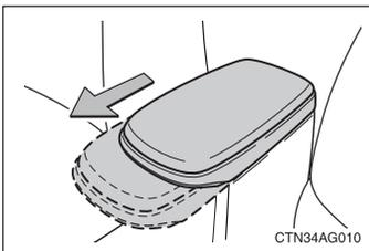
Se necessário, a tampa do console central poderá ser deslizada para frente. Puxe a tampa para frente segurando a parte dianteira da tampa.
