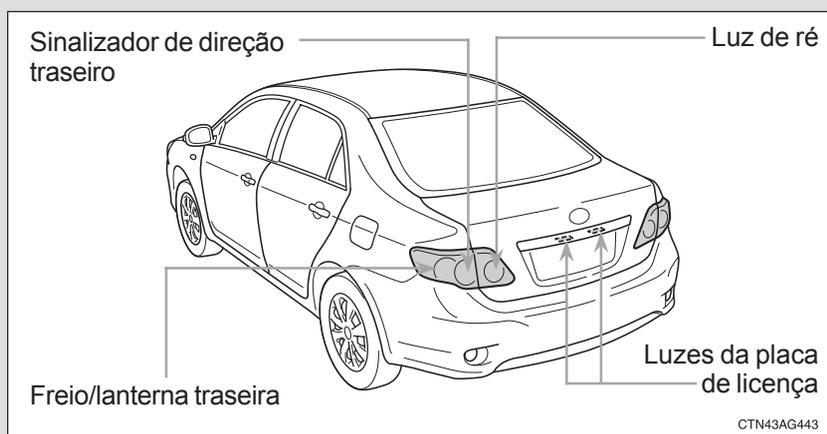
**Substituição de lâmpadas**
