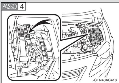
Remova o fusível usando a ferramenta de remoção.
