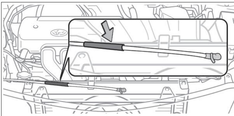
“Ao abrir o capô do veículo manuseie a haste que o sustenta somente na área destacada, conforme ilustração acima. A haste de sustentação do capô poderá atingir temperatura elevada devido a sua proximidade com o motor do veículo e causar queimaduras se manuseada de forma inadequada. Portanto, para sua segurança, não manuseie a haste de sustentação do capô fora da área de proteção”.
