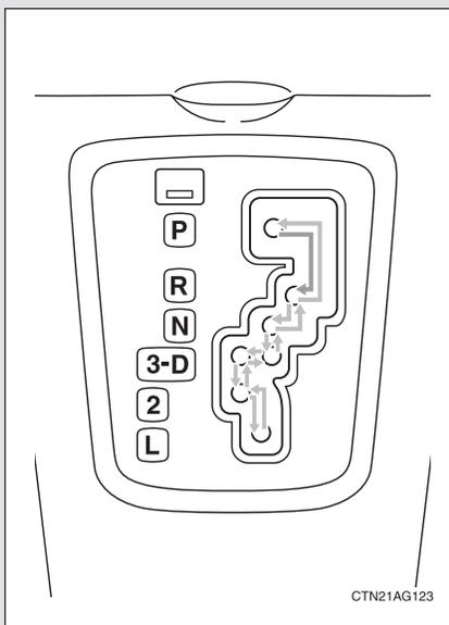
→ Com a chave de ignição posicionada em “ON”, pressione o pedal de freio e mova a alavanca de mudança de marcha.
