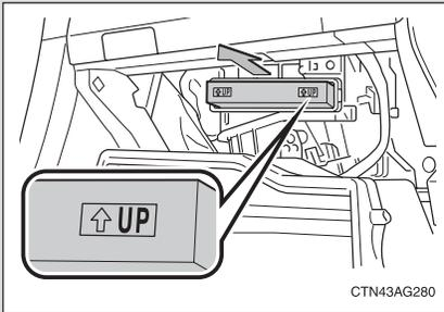
Remova o filtro do ar condicionado e substitua por um filtro novo.
