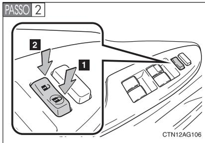
Posicione a alavanca de mudança de marcha em P ou N, e pressione e mantenha pressionado o interruptor da fechadura da porta do motorista (**1** ou **2**) durante aproximadamente 5 segundos e a seguir libere-o.
