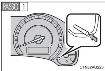
Pressione o botão no lado direito do conjunto dos instrumentos. Mantenha o botão pressionado por no mínimo 10 segundos após posicionar a chave de ignição em "ON", até que o indicador apresente "ON".
