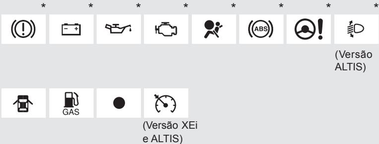
\*: Estas luzes irão acender quando a chave de ignição for posicionada em “ON” para indicar que a inspeção do sistema está sendo executada. As luzes irão apagar após a partida do motor, ou após alguns segundos. Poderá haver impropriedade em um sistema se uma luz não acender, ou se as luzes não apagarem. Providencie a inspeção do veículo em uma Concessionária Autorizada Toyota.
