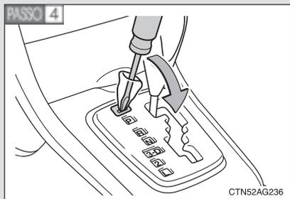
Alavanque a tampa usando uma chave de fenda ou equivalente.
