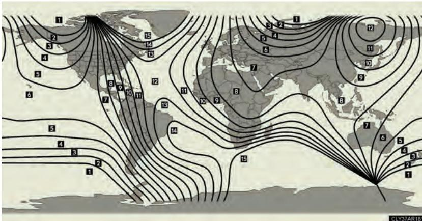
O mostrador de direção na bússola desvia da direção real determinada pelo campo magnético da terra. A quantidade de desvio varia conforme a posição geográfica do veículo.
