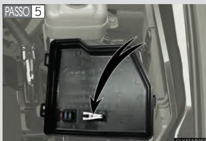
Remova o fusível usando a ferramenta de remoção.
