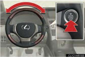
A luz indicadora verde no interruptor “ENGINE START STOP” irá piscar e uma mensagem será apresentada no mostrador multifunção. Pressione o interruptor “ENGINE START STOP” novamente ao mesmo tempo em que esterça o volante de direção para a esquerda e para a direita.
