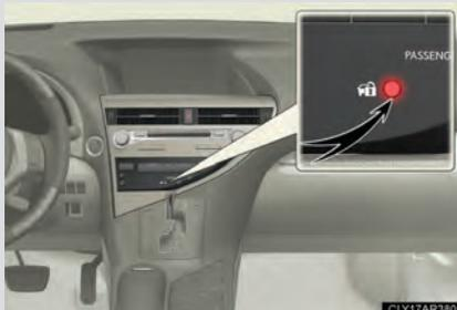
A luz indicadora irá piscar após o desligamento do interruptor "ENGINE START STOP", indicando que o sistema está funcionando.
