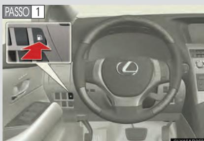
Pressione o dispositivo de abertura para abrir a tampa do reservatório de abastecimento.
