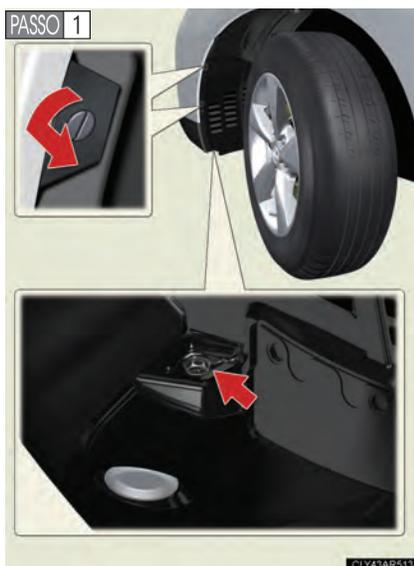
Para permitir espaço de trabalho suficiente, gire o volante de direção para o lado oposto da lâmpada a ser substituída.
