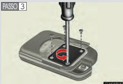
Remova os parafusos da tampa da bateria e remova a tampa da bateria.
