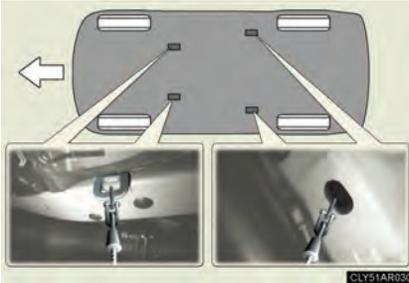
Se for transportado por um caminhão de plataforma, o seu veículo Lexus deverá ser amarrado nas posições indicadas na ilustração.
