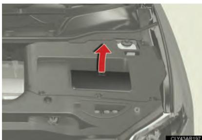
Remoção da tampa da bateria de 12 volts.
