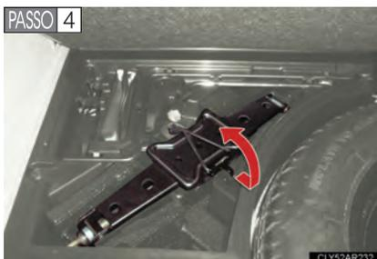
Remova o macaco após remover a trava de fixação.
