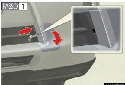
Introduza a chave mecânica (→P. 1-1-3) no sulco e solte as garras. Com a chave mecânica introduzida, remova a tampa do olhal puxando-a em sua direção.
