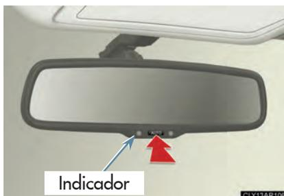
Alterar o modo automático da função antiofuscante
