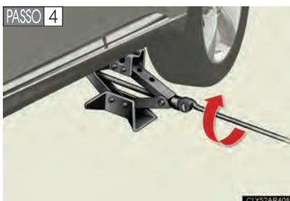
Levante o veículo até que o pneu esteja levemente levantado do solo.
