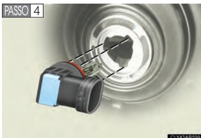
Substitua a lâmpada e instale a base da lâmpada.
