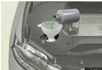
Se algum lavador não funcionar ou se uma mensagem for apresentada no mostrador multifunção, o reservatório do lavador poderá estar vazio. Adicione fluido do lavador.
