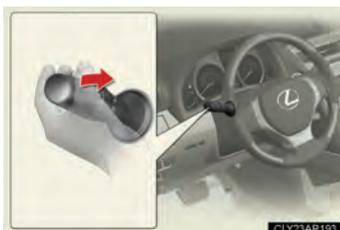
Desligue o motor com o interruptor de luzes em **AUTO** ou desligado, e puxe o interruptor em sua direção e solte-o. O fecho baixo dos faróis irá acender durante aproximadamente 30 segundos para iluminar a área próxima ao veículo.
