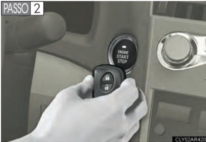
Toque o lado do emblema Lexus da chave eletrônica no interruptor “ENGINE START STOP”.
