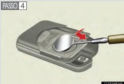
Remova a bateria descarregada. Introduza uma bateria nova mantendo o terminal “+” voltado para cima.
