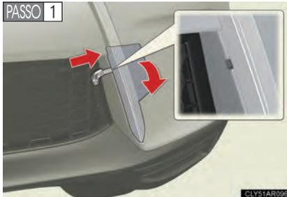
Introduza a chave mecânica (→P. 1-1-3) no sulco e solte as garras. Com a chave mecânica introduzida, remova a tampa do olhal puxando-a em sua direção.
