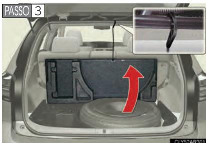
Use o gancho para fixar o painel conforme indicado na ilustração.
