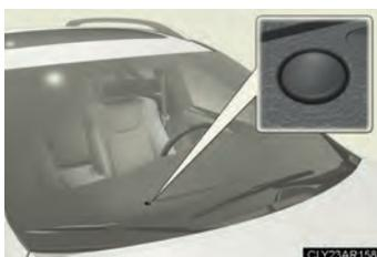
O sensor poderá não funcionar corretamente se um objeto for posicionado sobre o sensor, ou se algum objeto for fixado no para-brisa causando obstrução do sensor.
