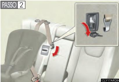
Abra a tampa do suporte de ancoragem, encaixe o gancho no suporte de ancoragem e aperte a cinto superior.
