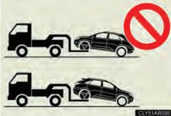
Jamais reboque este veículo com alguma das rodas apoiadas na pista. Isto poderá causar danos severos à transmissão e sistema 4WD de controle de torque ativo. Use um carrinho de rebocamento.
