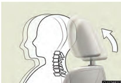
Quando a parte inferior das costas do ocupante é pressionada contra o encosto do banco durante uma colisão traseira, o apoio de cabeça move-se levemente para frente e para cima, para ajudar a reduzir o risco de lesões cervicais ao ocupante do banco.
