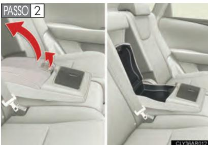
Puxe a alavanca para cima para destravar, e levante o descansa-braço.
