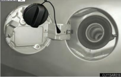
Mantenha a tampa fixada atrás da tampa do reservatório de abastecimento.
