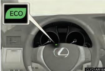
Durante a aceleração em condução Eco (Condução Eco), a Luz Indicadora de Condução Eco irá acender.
