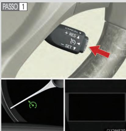
Pressione o botão "ON-OFF" para ativar o sistema de controle de velocidade.
