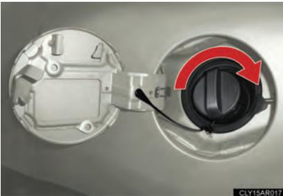
Após o reabastecimento, gire a tampa do reservatório de combustível até ouvir um "click". Após soltar, a tampa irá girar levemente no sentido oposto.
