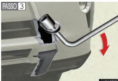
Usando a ponta da chave de roda, aperte firmemente o olhal de rebocamento sem interferir com o para-choque.
