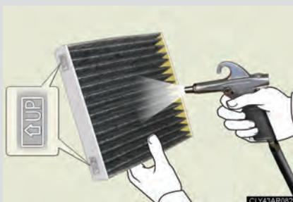
Se o filtro estiver sujo, limpe-o aplicando ar comprimido a partir do lado de baixo.
