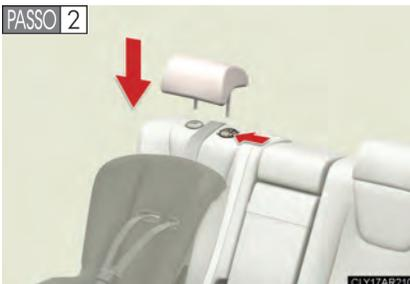
Reinstale o apoio de cabeça e levante-o até a posição de travamento mais alta possível.
