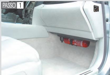
**PASSO 1** O extintor está localizado sob o painel no lado do passageiro. Para removê-lo, solte a presilha de fixação.
