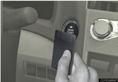
**PASSO 3** Para alterar os modos do interruptor “ENGINE START STOP”: No período de 10 segundos após o alarme soar, libere o pedal de freio e pressione o interruptor “ENGINE START STOP”. Os modos poderão ser alterados sempre que o interruptor for pressionado. (→P. 2-1-15)
