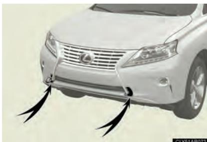
Se o caminhão de reboque não estiver disponível, em caso de emergência o seu veículo poderá ser rebocado temporariamente usando um cabo ou corrente fixados no(s) olhal(is) de rebocamento de emergência. Isto somente deverá ser feito em pistas pavimentadas durante percursos curtos e em velocidades baixas.
