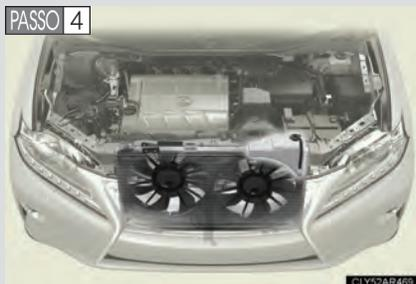
Após o motor esfriar suficientemente, verifique o nível do fluido de arrefecimento e inspecione o núcleo do radiador quanto a vazamentos.
