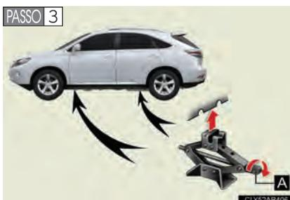
Manualmente, gire a parte "A" do macaco, até que o encaixe do macaco faça contato no ponto de levantamento.
