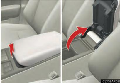
Puxe a alavanca para cima para destravar, e levante o descansab braço.
