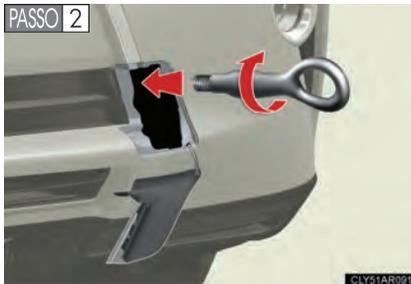
Introduza o olhal de rebocamento no orifício e aperte o máximo possível com a mão.
