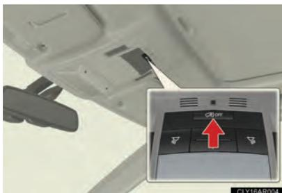
Desligue o interruptor "ENGINE START STOP" e pressione o interruptor de cancelamento do sensor de intrusão e sensor de inclinação.
