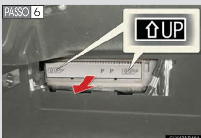
Remova o filtro do ar condicionado e substitua-o por um novo. A marca "↑UP" no filtro deverá estar voltada para cima.
