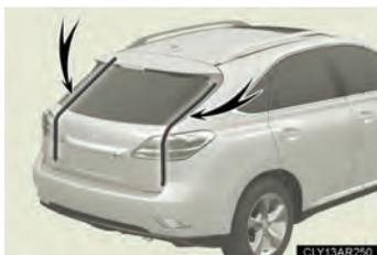
Os sensores estão fixados nos lados esquerdo e direito da tampa elétrica do porta-malas. Caso estes sensores detectem uma obstrução enquanto a tampa elétrica estiver sendo fechada, a função antiesmagamento irá retornar a tampa para a posição totalmente aberta.
