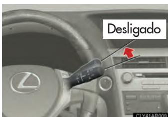
Ajuste o interruptor do limpador para a posição off.
