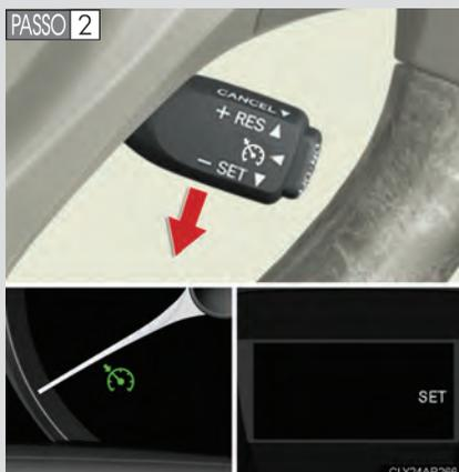
Acelere ou desacelere à velocidade desejada, e pressione a alavanca para baixo para selecionar a velocidade.
