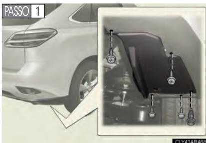
Remova os parafusos usando uma chave de fenda Phillips e remova a presilha.
