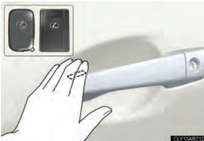
Toque no sensor de travamento (re-corte na parte superior da maçaneta da porta) para travar as portas.
