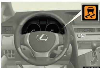
Se o veículo estiver em risco de derrapagem ou patinamento de uma das rodas de tração, a luz indicadora de patinamento irá piscar para indicar que os sistemas VSC/TRC estão em funcionamento.
