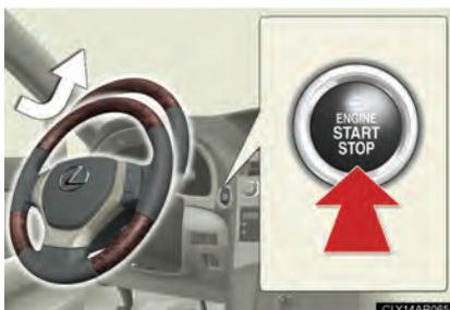
Quando o interruptor “ENGINE START STOP” for desligado, o volante de direção irá retornar à sua posição recolhida com movimento para cima e afastado para facilitar a entrada e a saída do motorista.
