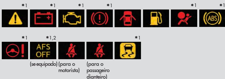
\*1: Estas luzes irão acender quando o interruptor “ENGINE START STOP” for posicionado no modo IGNITION ON para indicar que a inspeção do sistema está sendo executada. As luzes irão apagar após a partida do motor, ou após alguns segundos. Poderá haver impropriedade em um sistema se uma luz não acender, ou se as luzes não apagarem. Providencie a inspeção do veículo em uma Concessionária Autorizada da Marca Lexus.
