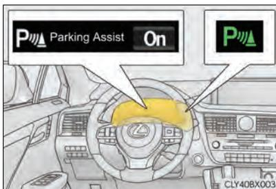
Quando ativado, o indicador do sensor do sistema Lexus de assistência a estacionamento acenderá para informar ao motorista que o sistema está em operação.
