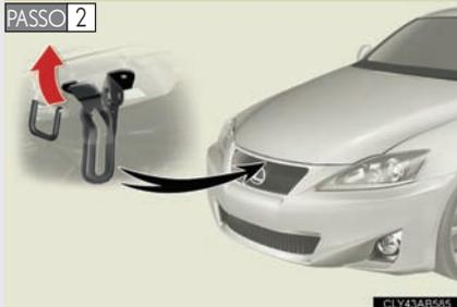
Levante a alavanca de trava auxiliar e levante o capô do motor.
