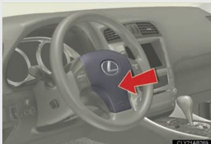
Para acionar a buzina, pressione a marca ou próxima da marca
