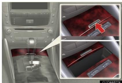
Pressione a parte de trás da tampa para abrir. Pressione a tampa novamente para fechar.
