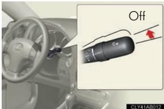
Ajuste o interruptor do limpador para a posição off.
