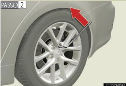
Solte levemente as porcas da roda (uma volta).
