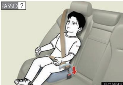
Coloque o assento auxiliar (booster) no banco voltado para a frente do veículo.
