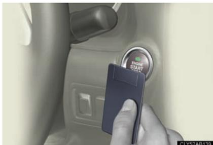
Toque o lado do emblema Lexus da chave eletrônica no interruptor “ENGINE START STOP”.
