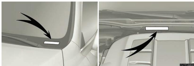
Esse número está gravado na parte superior esquerda do painel de instrumentos ou no compartimento do motor.
