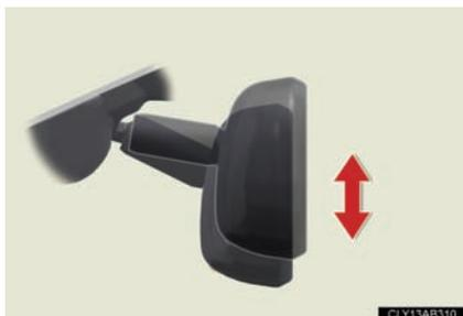
Ajuste a altura do espelho retrovisor movendo-o para cima e para baixo.
