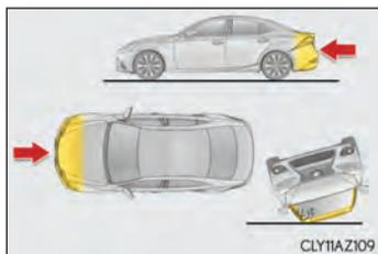
Os airbags de cortina geralmente não deflagram caso o veículo se envolva em uma colisão traseira, capote, ou se envolva em uma colisão lateral ou dianteira em baixa velocidade.
