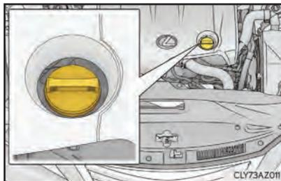
Assegure-se de verificar o tipo de óleo e prepare os itens necessários antes de adicionar óleo.
