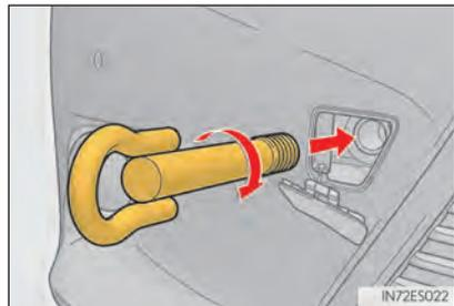
4 Aperte o olhal de reboque firmemente com uma chave de rodas.
