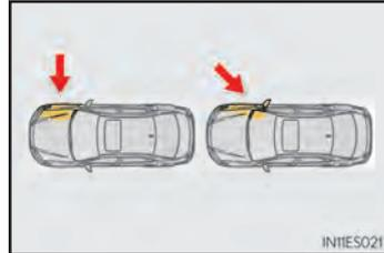
Os airbags laterais não foram projetados para deflagrar caso o veículo se envolva em uma colisão frontal ou traseira, capote, ou se envolva em uma colisão lateral em baixa velocidade.
