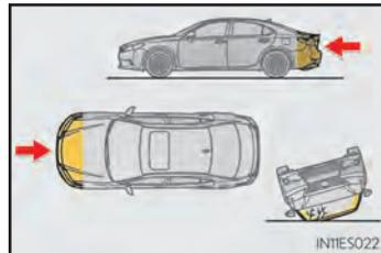
Os airbags de cortina e laterais não foram projetados para deflagrar se o veículo se envolver em uma condição traseira, se o veículo capotar, ou se ele se envolver em uma colisão lateral ou frontal de baixa velocidade.
