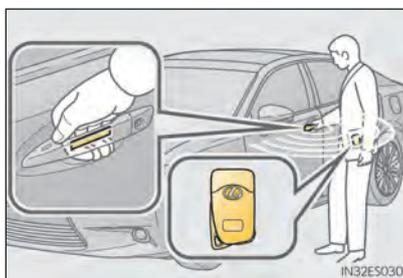
Toque no sensor de trava (na parte superior da maçaneta) para travar todas as portas.
