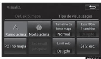
Cada toque da tecla liga e desliga a exibição do marcador de rua de mão única na escala de 100 m.
