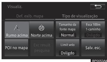
Cada toque na tecla liga e desliga a exibição do marcador de rua de mão única na escala de 100 m.
