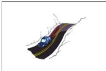
Nunca desça com o veículo na marcha neutra. Porque, em caso de necessidade, você não vai ter a força do motor para ajudar a parar, ou a reduzir a velocidade, e os freios podem não ser suficientes.
