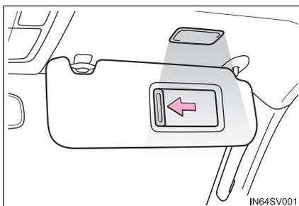
Veículos com luzes de cortesia: Se as luzes de cortesia permanecerem acesas por 20 minutos enquanto a chave de ignição é colocada na posição “LOCK” (veículo sem sistema inteligente de entrada e partida) ou depois que o botão de partida é desligado (veículo com sistema inteligente de entrada e partida), as luzes apagarão automaticamente.
