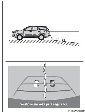
Quando qualquer parte do veículo for rebaixada devido ao número de passageiros ou a distribuição da carga, há uma margem de erro entre as linhas-guia na tela e a distância/curso real na estrada.
