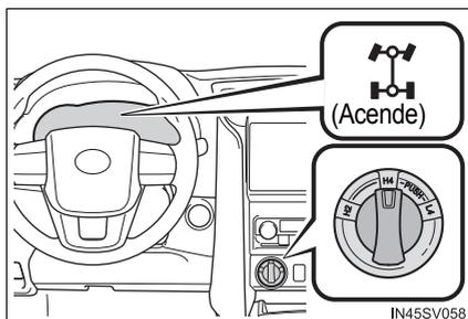
Se a luz indicadora de tração nas 4 rodas não parar de piscar depois da comutação do interruptor de controle de tração dianteira de H2 para H4, realize qualquer um dos itens descritos a seguir ao conduzir em linha reta.
