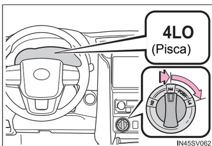
Se a alavanca for colocada em uma posição diferente de N enquanto a luz indicadora de tração nas quatro rodas em baixa velocidade estiver piscando, um ruído de engrenagem poderá ser ouvido. Mude a alavanca de mudança de marchas para N imediatamente, e espere que a comutação do modo de transferência seja concluída.
