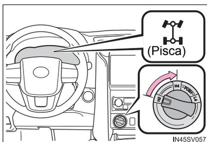
Se o interruptor de controle de tração dianteira for pressionado enquanto o veículo estiver em velocidades superiores a 100 km/h, a luz indicadora de tração nas quatro rodas pisca e o alarme sonoro soa.
