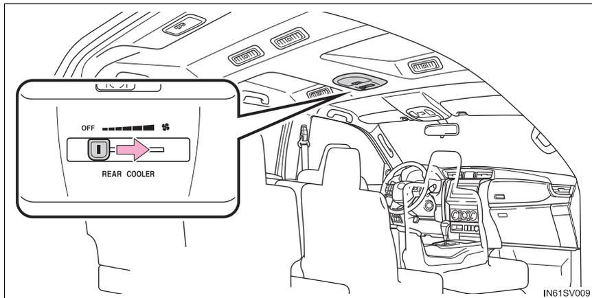
Para ajustar a velocidade do ventilador, empurre a alavanca de controle de velocidade para a direita (aumento) ou para a esquerda (redução).
